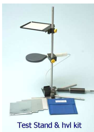
Support pour HVL et support de sondes (Hors sondes et Kit présentés)
