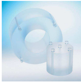
Fantôme PMMA Tête (160 mm de diamètre) et Corps (320 mm de diamètre)
